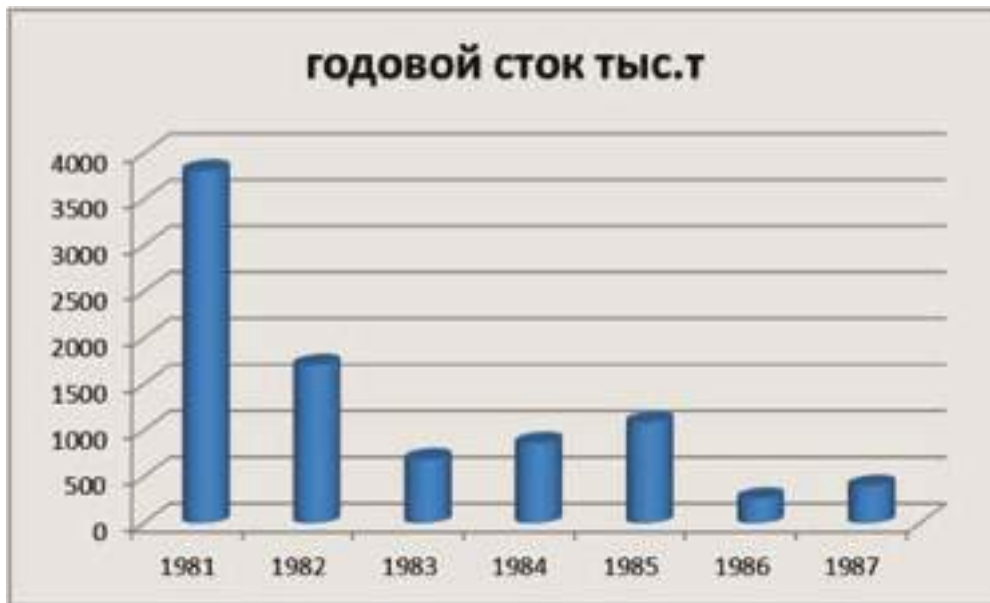
Рис. 2. Динамика среднегодового стока взвешенных веществ до и после ввода в эксплуатацию Днестровского водохранилища -ГЭС 1, по створу у г. Бендеры
